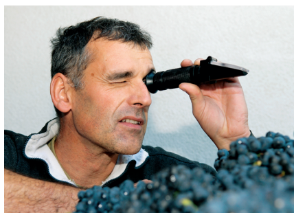
Ideale Werte: Ueli Liesch misst den Zuckergehalt mit dem Refraktometer.
