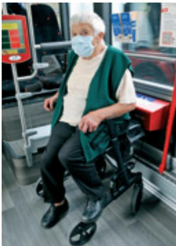
Ein Rollator kann älteren Menschen helfen, wenn das Gehen aus unterschiedlichen Gründen schwerfällt. Mit dem Rollator im Bus unterwegs zu sein, kann aber herausfordernd sein. Das soll der «Rollator Rest» ändern. Die Idee ist simpel: Wie einen Sicherheitsgurt im Auto zieht man beim «Rollator Rest» eine Matte aus einem Metallbehälter an der Wand. Diese Matte legt man über den mit den Bremsen fixierten Rollator. Dadurch entsteht für die Fahrgäste
