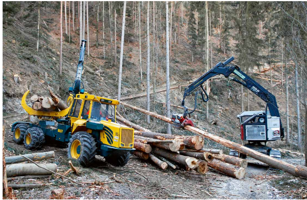
Unromantisch, aber effizient und wirtschaftlich: Der Vollernter und der Kombischlepper im Gebiet Kalkofen im Einsatz.
