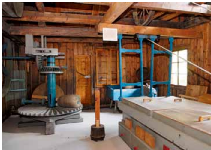
Einzigartige Raritäten: Die Rundieranlage und das Schüttelwerk sind noch gut erhalten und voll funktionsfähig.
