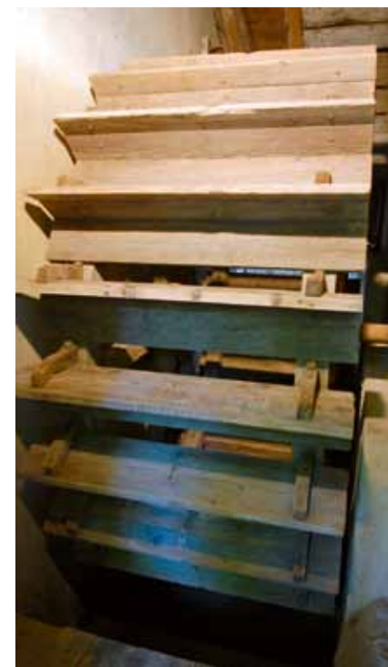
Ganz aus Holz gefertigt: Vier mehrere Meter hohe Wasserräder trieben die zahlreichen Maschinen zur Schwarzpulverherstellung an.
